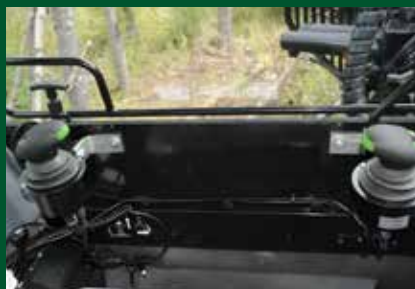
HP Propo BLB pour séries 46 - seulement 2 joysticks en cabine
