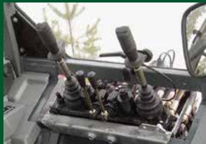
HP Propo Bucher pour série 62 - seulement 2 mini joysticks en cabine
