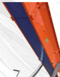
Couverture inférieure du tapis avec une tôle de protection.
